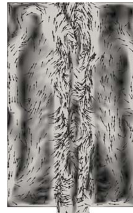
Рис. 5. Распределение осевых и радиальных скоростей в сечении циклонной камеры
